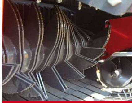
Infaldatore con rotore. / Rotor feeding system. / Alimentador simple con rotor. / Plieuse à rotor.
