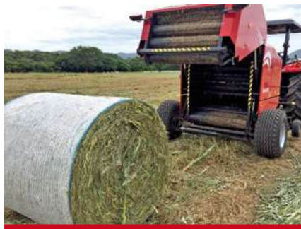
Legatura a rete. / Net wrapping system. / Fardo con malla. / Liage à filet.
