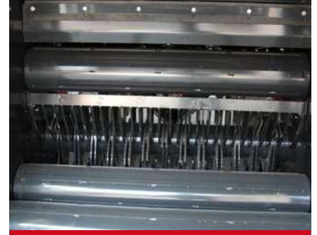
Camera di compressione a 16 rulli. / Baling chamber with 16 rollers. / Cámara de compresión con 16 rodillos. / Chambre de compression à 16 rouleaux.
