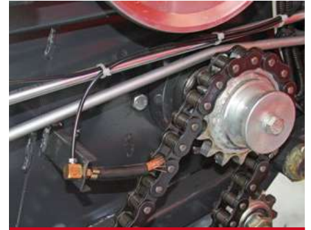
Lubrificazione a olio. / Oil lubricating system. / Lubricación en aceite. / Graissage à bain huile.
