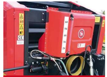
Deposito liquido per alimento. / Liquid applicator. / Deposito per inoculante. / Dispositif liquide pour nourriture.
