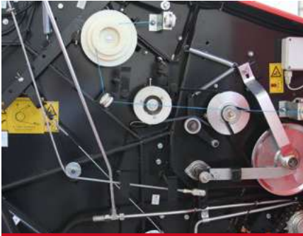
Facile da registrare la densità della balle. / Easy way to set the bale density. / Fácil para registrar la densidad del fardo / Densité de balle aisément réglable.
